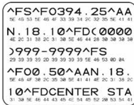
Figure 15 • Wydruk wyników testu diagnostycznego łączności
